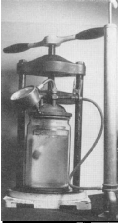
Abb. 1. Druckkessel und Entkalkungsgefäss. Zur Beachtung! Die Verstärkung des Kessels mit Leucoplaststreifen unbedingt notwendig, hier jedoch nicht ausgeführt um bessere Anschaulichkeit zu ermöglichen. Aus dem gleichen Grund ist auch das Wasser zwischen den beiden Glasgefässen nicht eingefüllt worden, was dagegen in Abb. 3 gezeigt wird.
